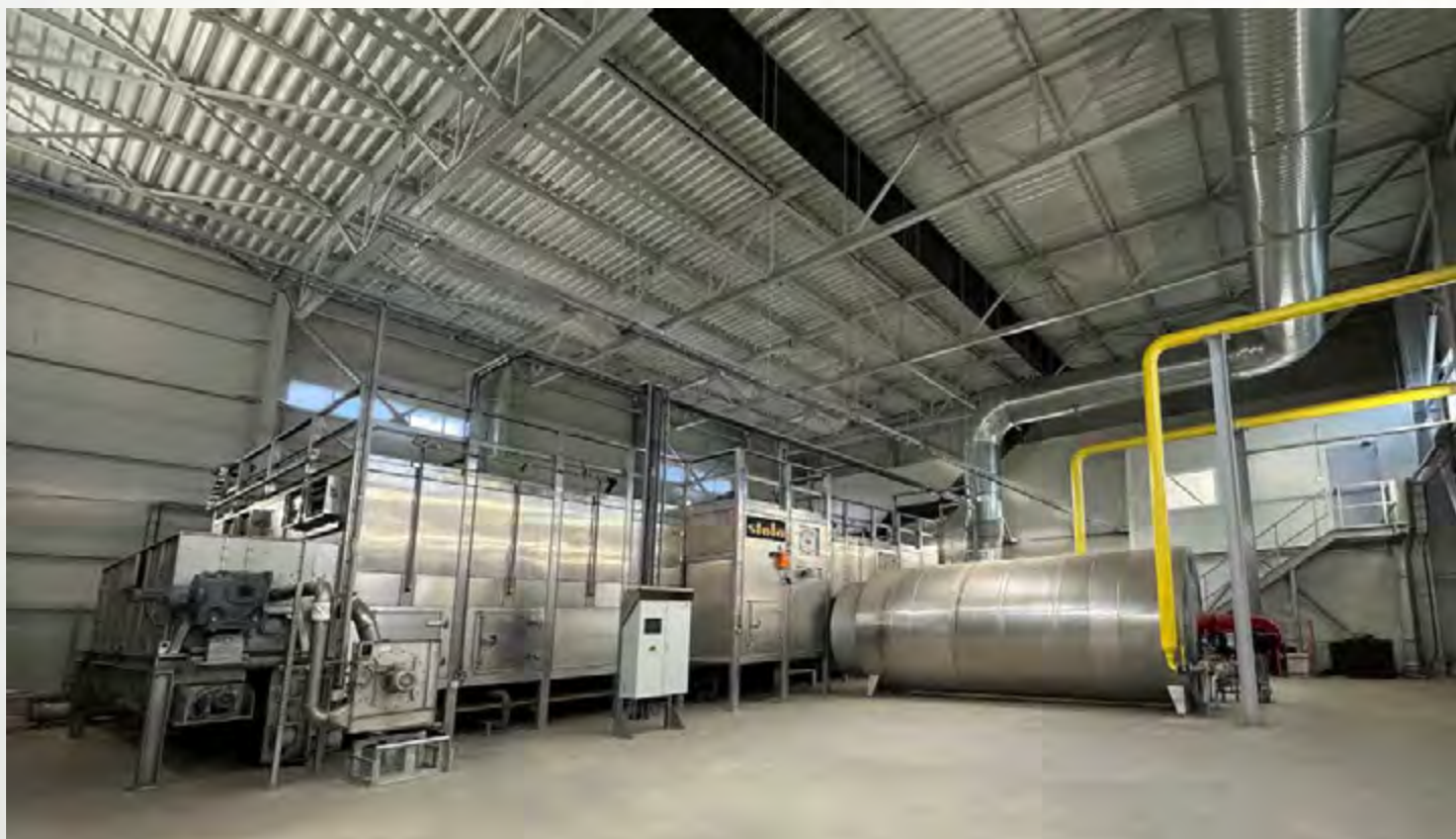
项目地：SC Raja SA, 罗马尼亚 | 型号：BTU 1/6200-18 | 安装年份：2022 干燥物料：市政污泥 | 蒸发量：3.1吨/小时
