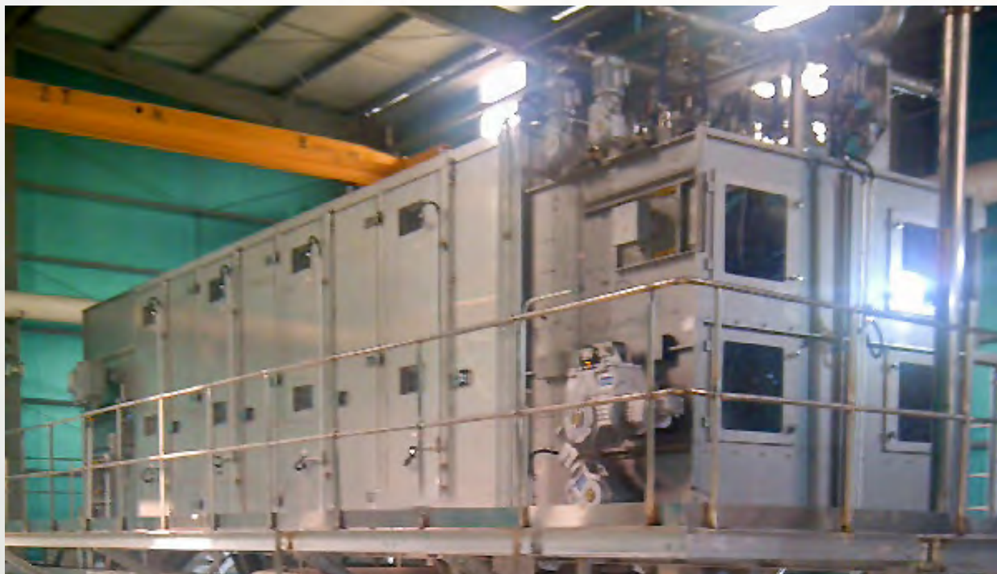
项目地：Ekosep Engineering, 中国 | 型号：PBT 2/2500-8 | 安装年份：2015 干燥物料：市政污泥 | 蒸发量：694公斤/小时
