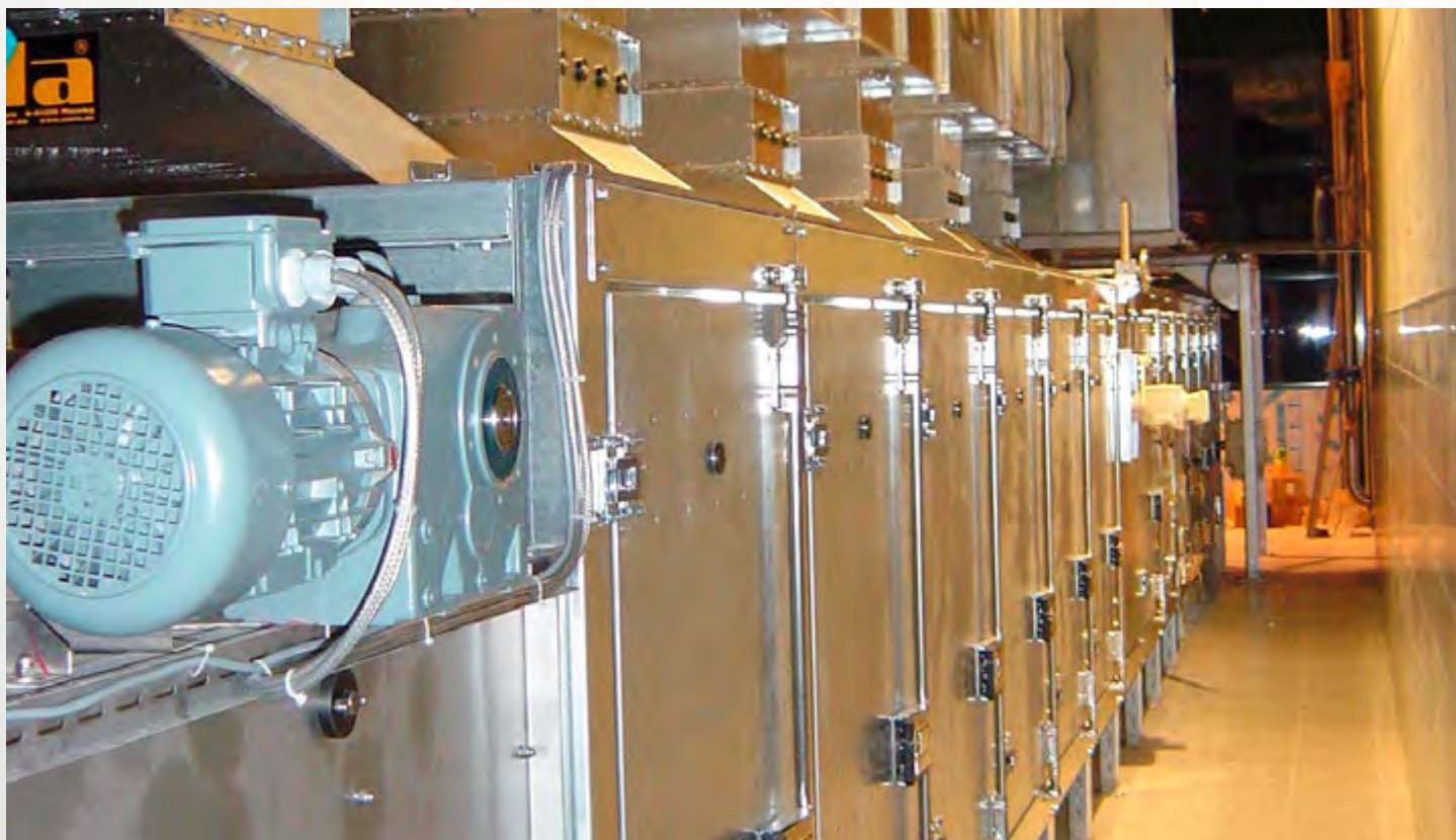
项目地：ARA Sölden, 奥地利 | 型号：PBT 1/2500-13 | 安装年份：2002 干燥物料：市政污泥 | 蒸发量：800公斤/小时
