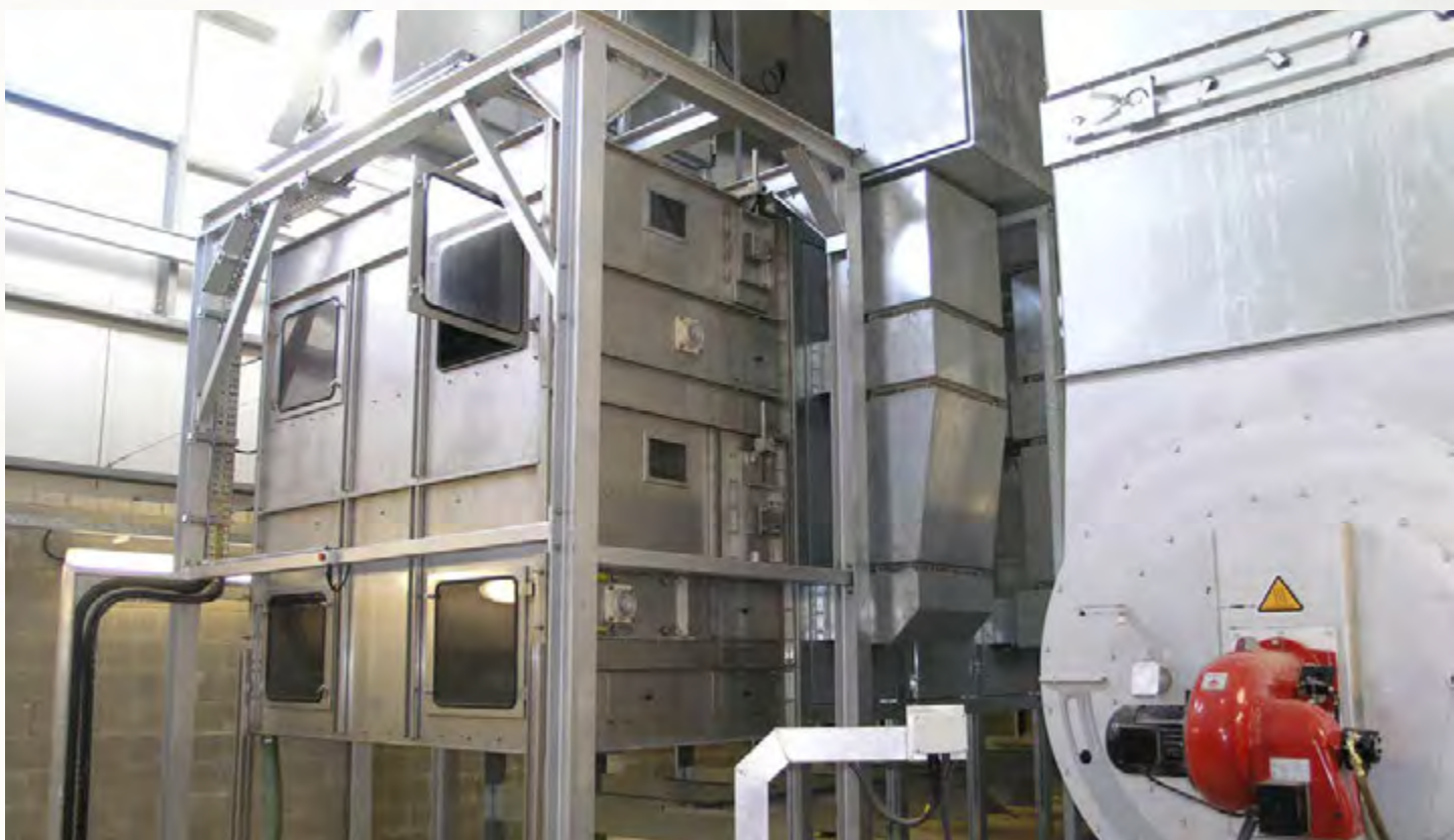
项目地：Wexford, 爱尔兰 | 型号：PBT 2/2500-12 | 安装年份：2003 干燥物料：市政污泥 | 蒸发量：1,250公斤/小时
