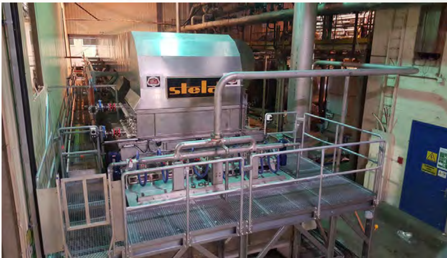
项目地：Ecoson Belgie BVBA, 比利时 | 型号：BTLU 1/3000-18 | 安装年份：2020 干燥物料：脱水污泥 | 蒸发量：707 公斤/小时
