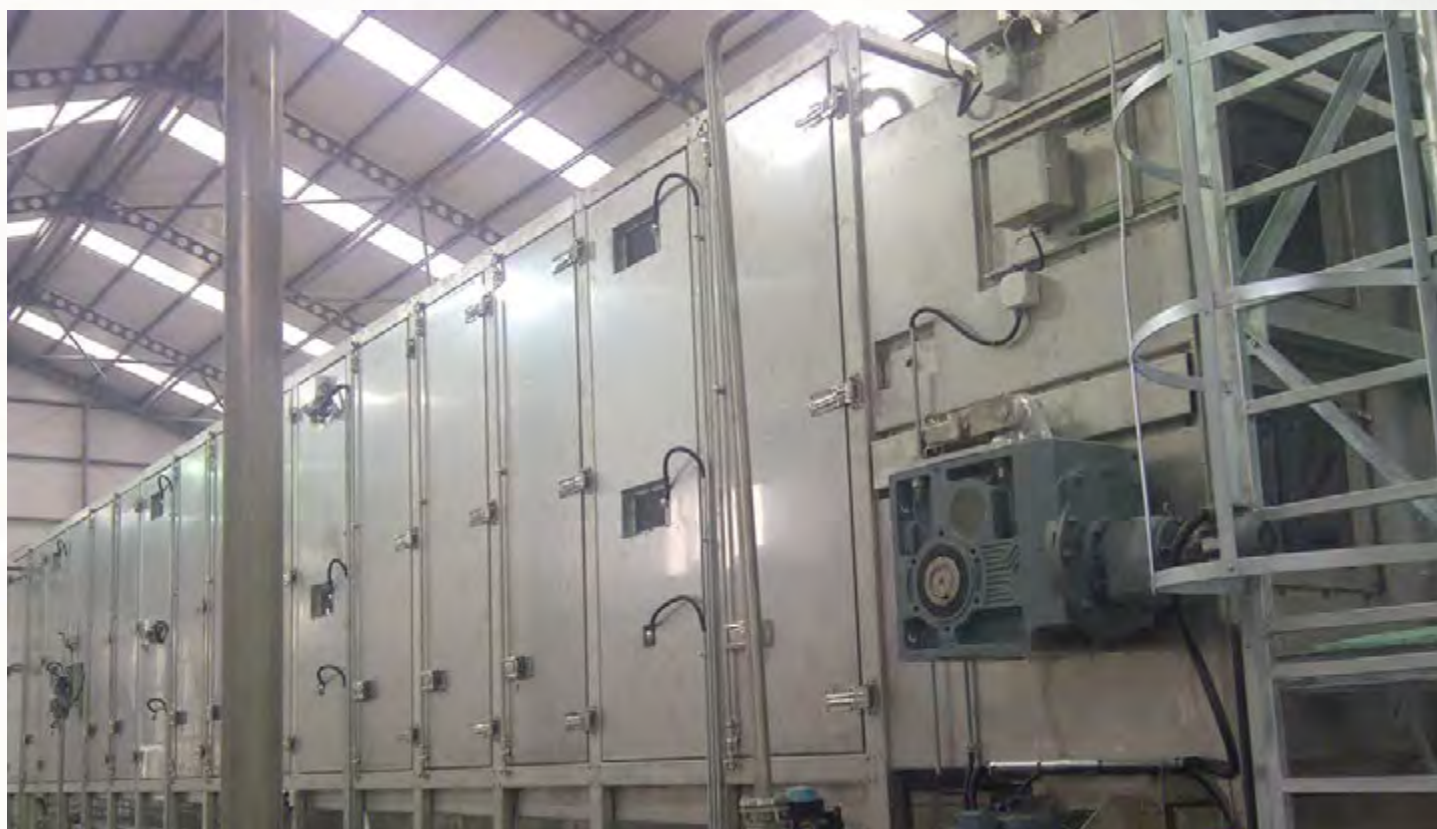
项目地：Corlu Leather, 土耳其 | 型号：2x PBT 2/2500-28 | 安装年份：2014 干燥物料：市政污泥 | 蒸发量：2.9吨/小时
