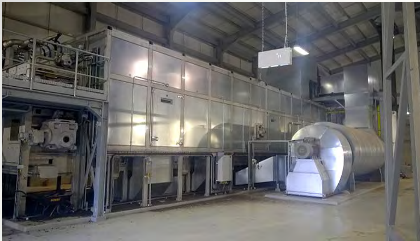
项目地：Veolia Water DB, 爱尔兰 | 型号：PBT 2/4000-18 | 安装年份：2017 干燥物料：市政污泥 | 蒸发量：3.4吨/小时
