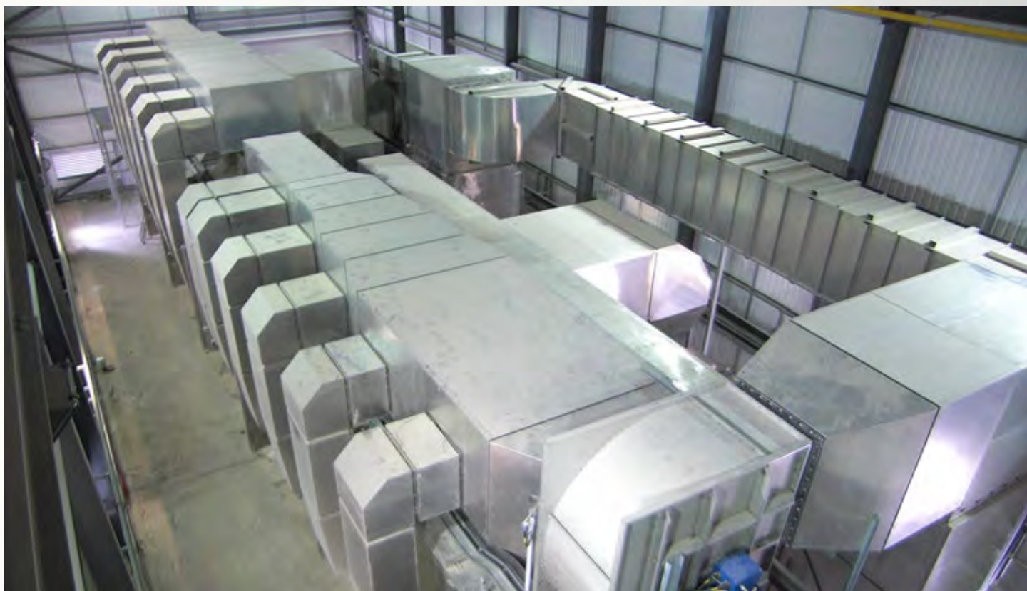
项目地：Euroby, 英格兰 | 型号：PBT 2/2500-24 | 安装年份：2008 干燥物料：市政污泥 | 蒸发量：3,000公斤/小时
